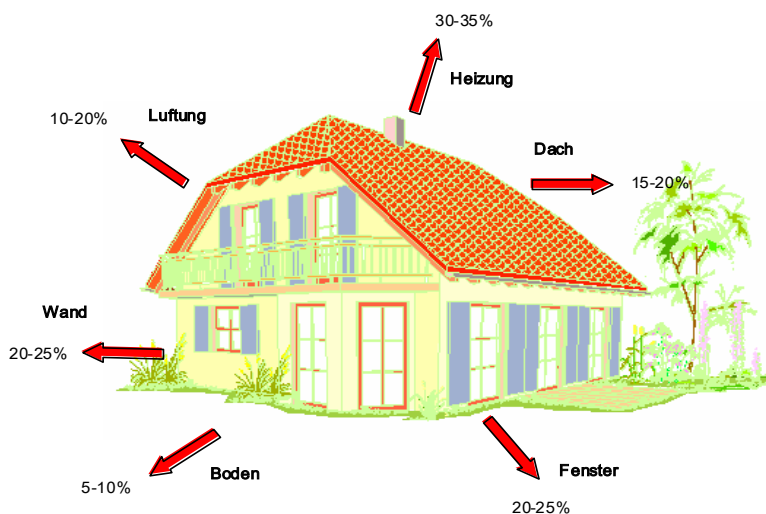
Abbildung 48: Energieverluste eines nicht modernisierten Hauses
