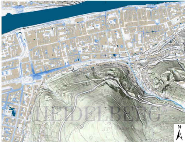
Abb.: Überflutungstiefen der Starkregensimulation / Bereich Altstadt
